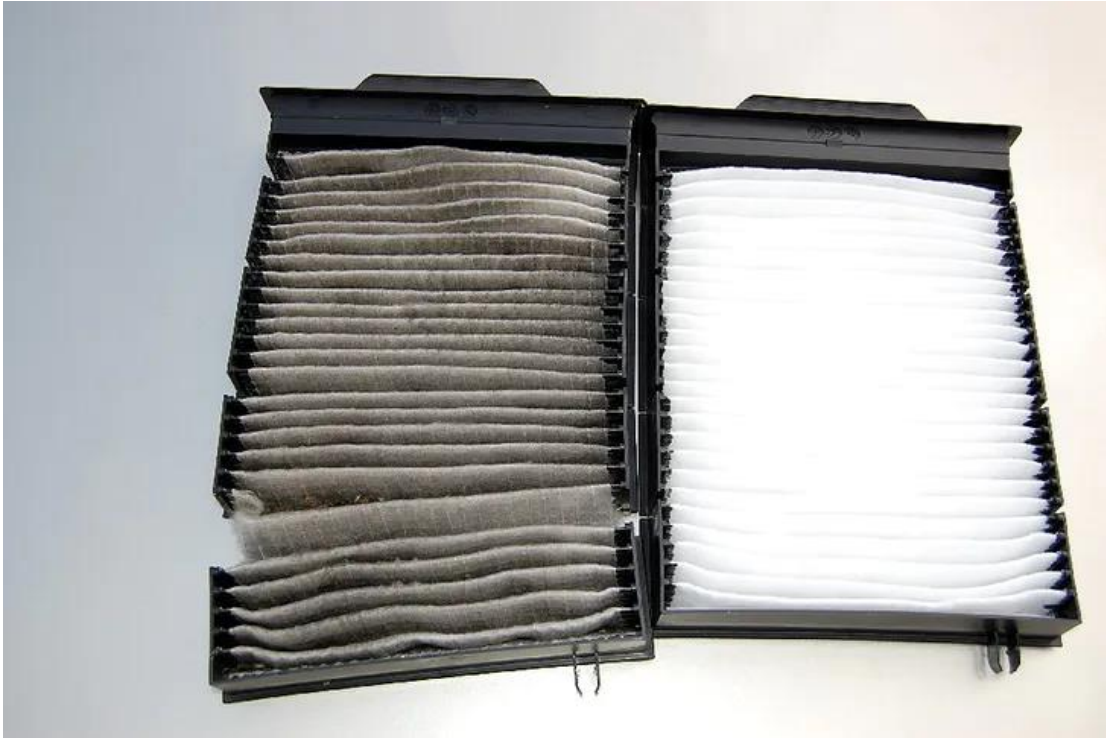
Filtr kabinowy po przebiegu 40 tys. km oraz nowy filtr fot. www.renaultforums.co.uk
