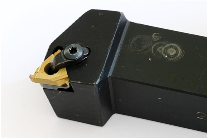
Nóż tokarski z wymienną wielostrzową płytką
